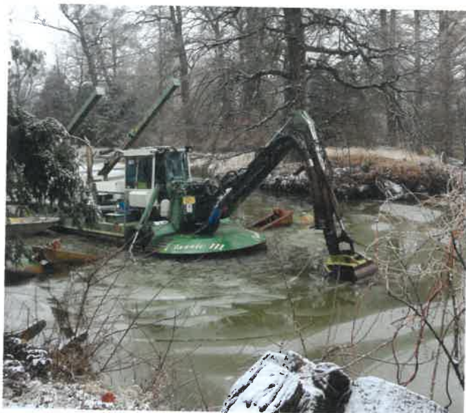
Sací bagr se zabývá na Zámeckém rybníku v Lednici. Jakmile povolí mráz, může začít odsávání sedimentů ze dna rybníka. Příhodné podmínky nastanou podle meteorologů přibližně od 19. února 2021.
